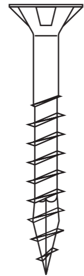
12x 3,5 x 40 mm Teilgewinde Edelstahl rostfrei A2
