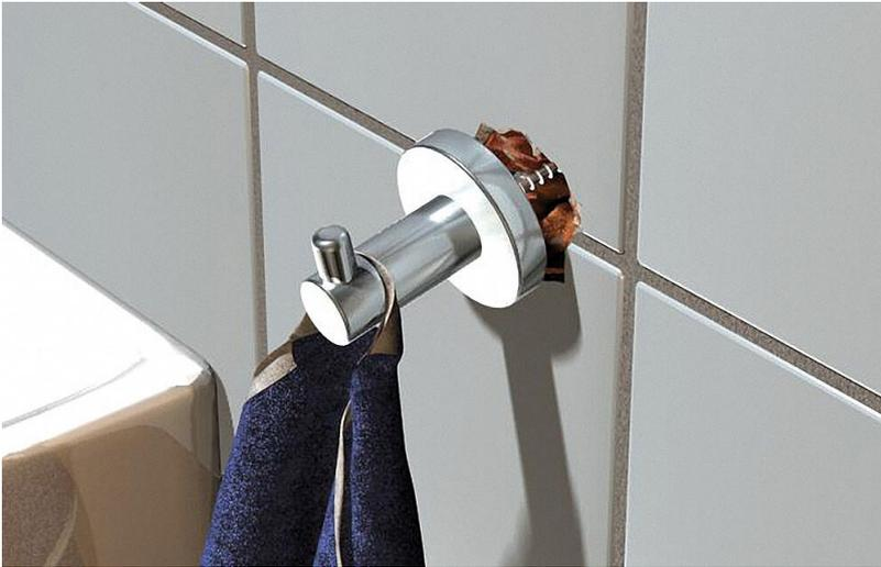
Das Badezimmer ist ein besonderer Ort für Befestigungen. Sind die Wände gefliest, solltest du einige Hinweise beachten: Ein aufgeklebtes Kreppband und eine vorsichtig vorgebohrte Mulde verhindern ein Abrutschen des Bohrers und Splintern an den Lochkanten. Außerdem solltest du die Schlag- oder Hammerfunktion ausstellen und dann mit langsamer Drehzahl und wenig Druck in rechtwinkliger Haltung bohren.
